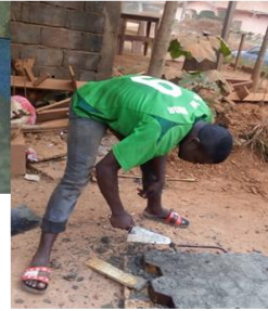
Jeune fabriquant des pavés à base des bouteilles plastiques à Yaoundé
